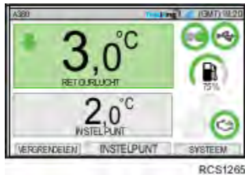
Afbeelding 34. Display Verse modus weergegeven
