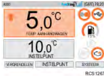
Afbeelding 35. Display verwarmingsmodus weergegeven
