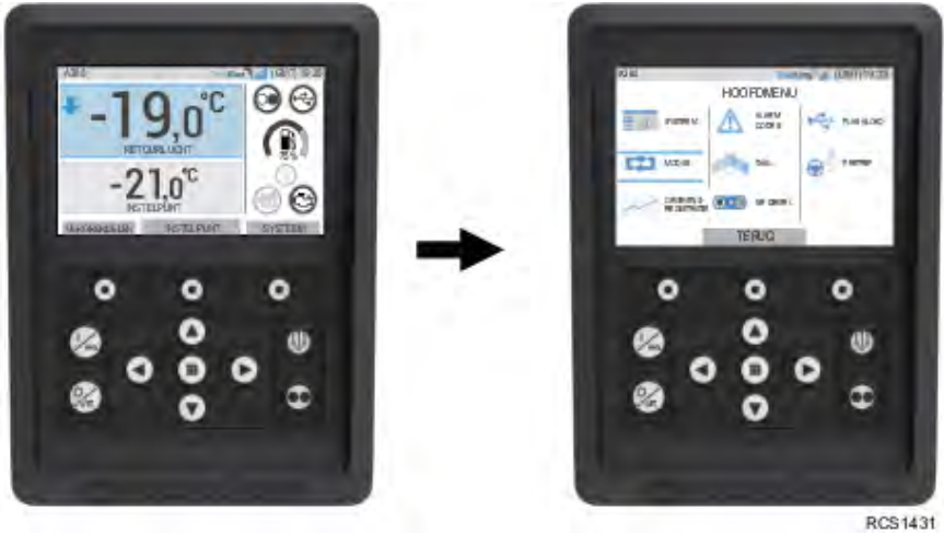
Afbeelding 13. Standaarddisplay en hoofdmenu display weergegeven
