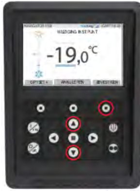
Afbeelding 29. Display instelpunt weergegeven
