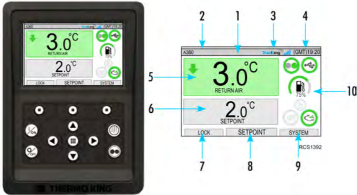
Afbeelding 11. Standaarddisplay en pictogrambeschrijvingen weergegeven
