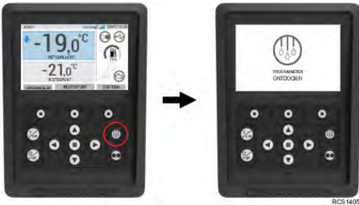
Afbeelding 30. Display ontdooiingsmodus weergegeven
